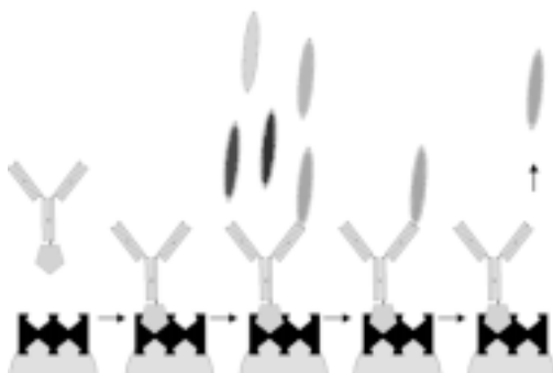
RYCINA 4. Phage display – schemat selekcji ligandów. Używane do selekcji przeciwciała 14G2a przeciw G_{D2} są immobilizowane na płytkach 96-studzienkowych. Następuje inkuwacja biblioteki, po czym wolne bakteriofagi są starannie odpłukiwane. Fagi związane na przeciwciałach wymywa się i infekuje E. coli szczepu K91. Namnożone fagi stanowią bibliotekę pośrednią używaną w kolejnych rundach selekcji
